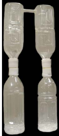
図2 二つのペットボトル振動子の上部をチューブで繋いだ様子。
